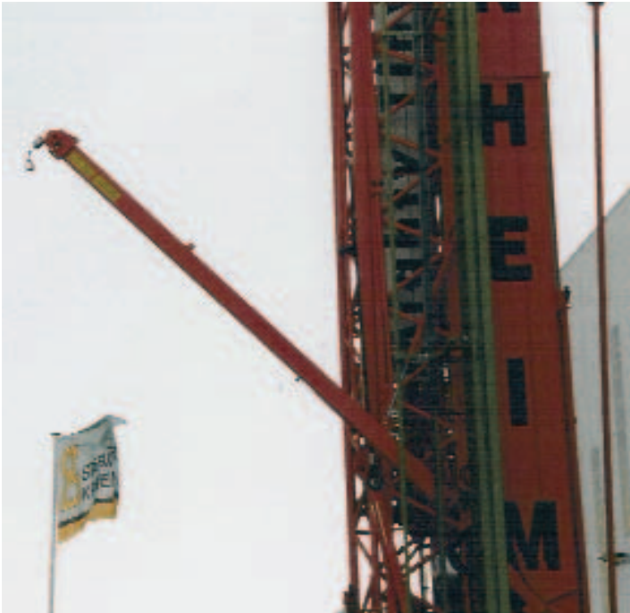
Ein pfiffiges Detail: Der integrierte Hilfskran klappt aus, nachdem der Turm aufgerichtet ist und bevor sich der Ausleger entfaltet. Mit ihm können dann die Abstützplatten gelegt werden. KM-Bild
