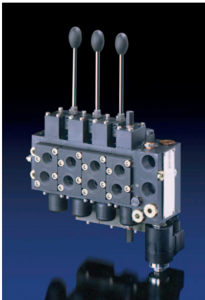
Dieser kleinste Wegeschiebertyp ist als Ventilverband aufgebaut. Er ist für individuelle Volumenströme von 3 bis 54 l/min bei einem maximalen Betriebsdruck von 420 bar konzipiert.
