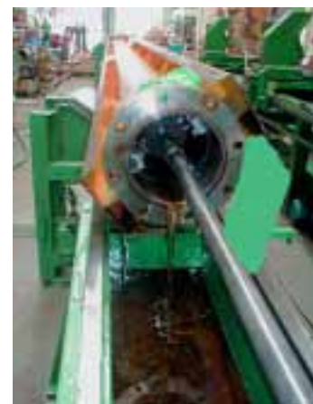
Der Teleskopzylinder wurde zerlegt und komplett überholt. Das Rohr wurde gehont und der Zylinder mit neuen Dichtungen zusammengesetzt. Vor dem Einbau in den Kran wurde der Zylinder einer Druckprüfung unterzogen.
