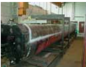
Die Teleskopstufen waren eingebault. Die Teleskopstufe auf dem Bild wurde durch Erneuerung des Obergurtes repariert. Die Schweißnähte werden anschließend durch Röntgenprüfung auf Fehlerfreiheit geprüft.
