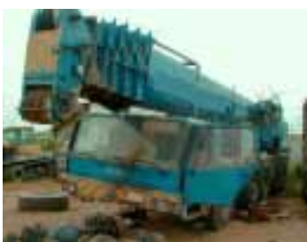
Der Liebherr LTM 1160-2 war in Afrika beim Einsatz und dort beim Arbeiten umgestürzt. Der Ausleger, der Wippzylinder, die Abstützung und die Krankabine waren stark beschädigt. Die Krankabine wurde ersetzt, unbeschädigte Einbauteile wurden wieder verwendet.
