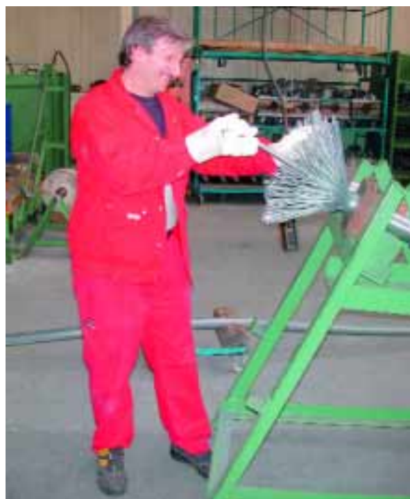
Obwohl bei der Seilkonfektionierung modernste Technologien zum Einsatz kommen, erfordern manche Arbeitsschritte echte Handarbeit. So zum Beispiel das Spleißen bestimmter Seile, das den Mitarbeitern ebenso Kraft als auch Sorgfalt abverlangt. KM-Bild
