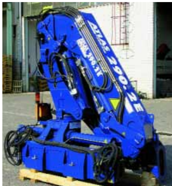
Ein Novum bei Atlas-Terex: Wird bei diesem Gerät die Option Z-Arm gewünscht, so sind auch die Traglasten am Z-Arm in das System der Leistungssteigerung über LM-plus eingeschlossen. Die gesamte Steuerung des Systems erfolgt über ein erweitertes ACM-System. Der Z-Arm hat, auch das ist neu, drei hydraulische Ausschübe. Reichweiten von 24,5 m und Reichhöhen bis zu 27 m ergeben einen sehr großen Arbeitsbereich. Auch die Ausführung mit Z-Arm ist in Kürze möglich für Geräte A4 bis A5.
