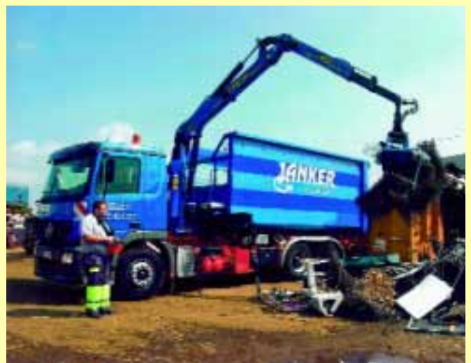
Präzise und schnell führt der Epsilon-Recycling-Kran des Typs E90L die einzelnen Befehle per Hetronic-Funkfernsteuerung aus. Die elektro-hydraulischen Ventile werden direkt ohne den Umweg über eine Ansteuer-Elektronik angesprochen. Bild: S. Rixner
