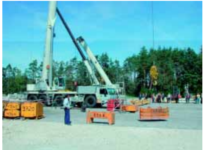
Sichtbar reduziert der Liftadjuster das Ausschwingen der Last beim Anheben.
