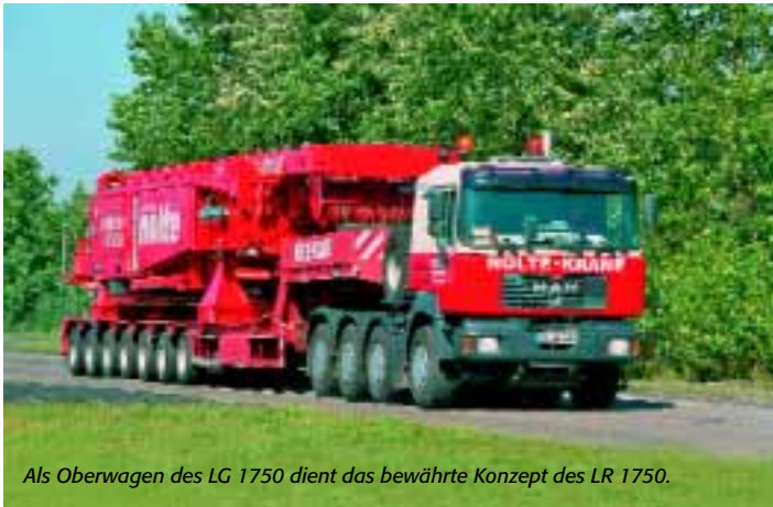
Der völlig neu entwickelte 8-achsige Unterwagen des LG 1750 auf dem Weg zum Einsatz.
