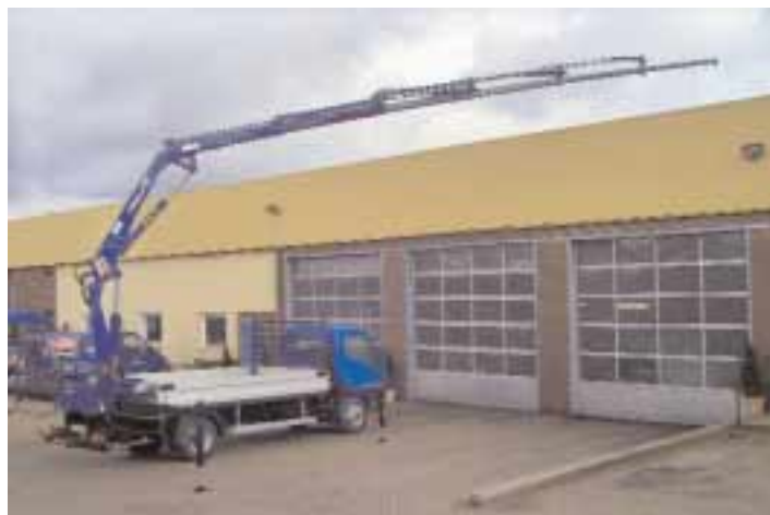
Einen Ladekran des Typs Euro 111 baute Tirre für einen Steinmetzbetrieb auf einen 7,5 t Mitsubishi Leicht-Lkw. Trotz des mächtigen Krans bleiben dem Anwender ca. 1.100 kg Nutzlast auf der Ladepritsche erhalten.
