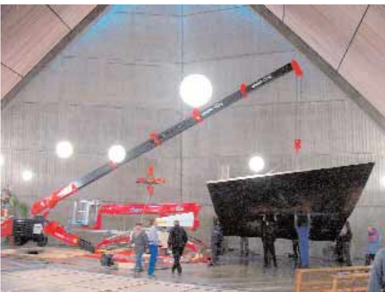
Mit einem Hakenradius von 15,5 m und einer Arbeitshöhe von 15,8 m stellt der URW-A506 CL E einen nahezu quadratischen Arbeitsbereich zur Verfügung, wodurch ...
