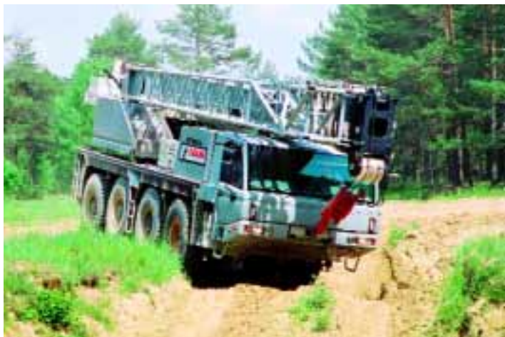
Der ATF 65G-4 stellte auf dem Truppenübungsplatz bei Amberg seine Geländetauglichkeit unter Beweis. KM-Bild
