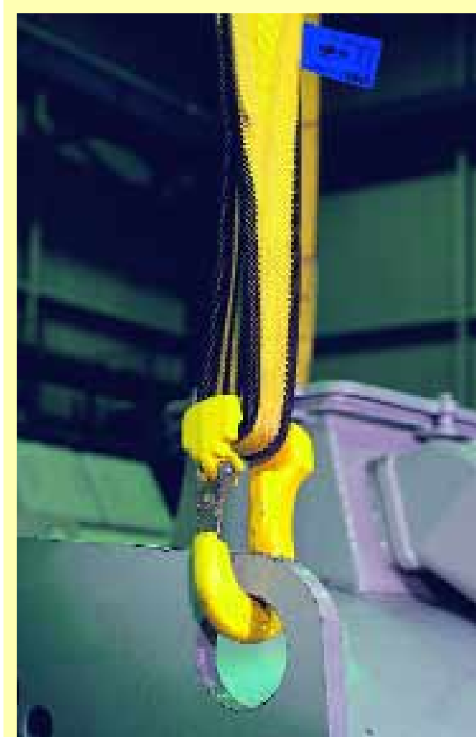
Rundschlingen eignen sich für Lasten aller Art, von oberflächenempfindlichen bis zu scharfkantigen Lasten, wenn zum Beispiel mit secutex-Schutzschläuchen gearbeitet wird.
