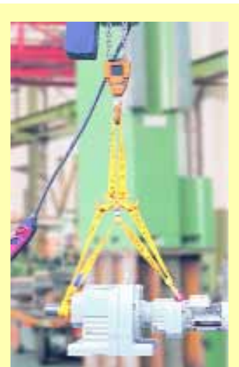
Mit der VarioSling kann eine Rundschlinge um bis zu 50 % der Nutzlänge verkürzt werden. Es ist auch möglich, ein Zweistranggehänge aus einer Rundschlinge und einem VarioSling in Verbindung mit einem Jokerhaken herzustellen. Bild: SpanSet
