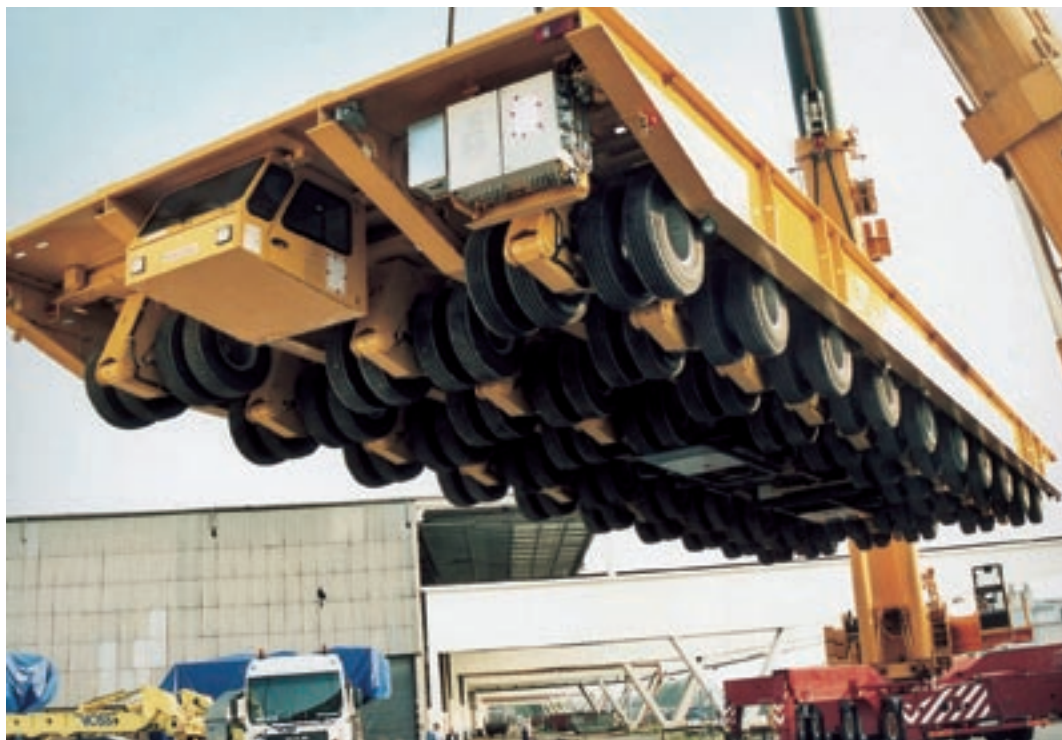
Der 23 m lange Schiffssektionstransporter von Scheuerle auf dem Weg zu seinem Bestimmungsort in Korea.
