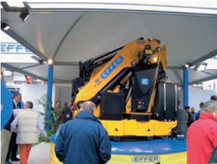
Einer der Stars am Effer-Stand war das neue Octopus-Modell 305, das eine Hubkapazität von 28 tm bietet und mit maximal 8 hydraulischen Ausschüben erhältlich ist. Die maximale horizontale Reichweite liegt bei 22 m bzw. 26 m (mit 4S fly-jib). KM-Bild
