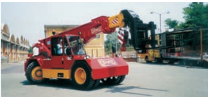
Ormig präsentierte den neuen 25 tmE „pick & carry“. Der batteriebetriebene Kran bietet 25 t Tragfähigkeit und begnügt sich mit einer Höhe von nur 2,4 m.
