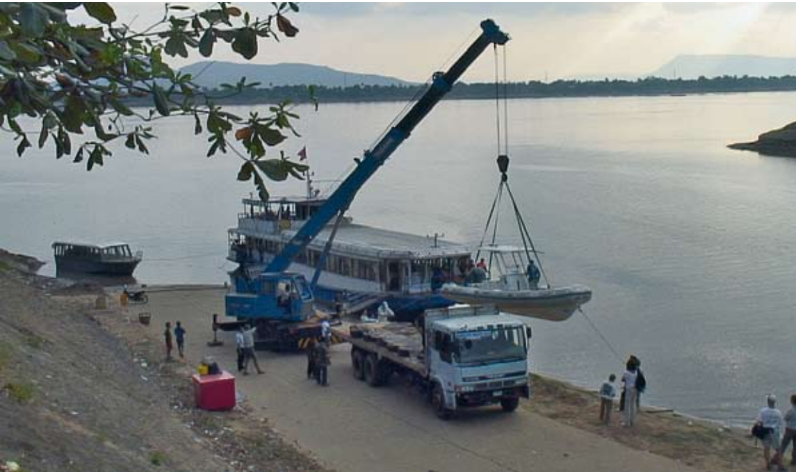
Umsetzen der Rips vor den Stromschnellen mit örtlichem Autokran.
