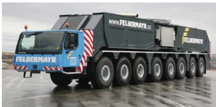
Der Unterwagen des LG 1750 kann inklusive der kompletten Abstützungen verfahren werden.
