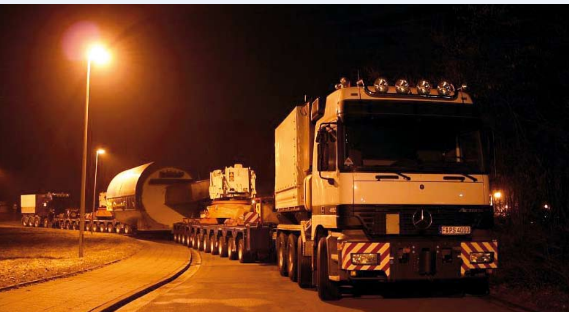
Transport zum und Verladung eines 400 t schweren Generators im Hafen von Ibbenbüren.
