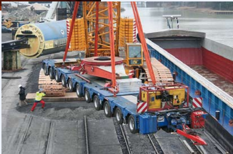
Transport zum und Verladung eines 400 t schweren Generators im Hafen von Ibbenbüren.
