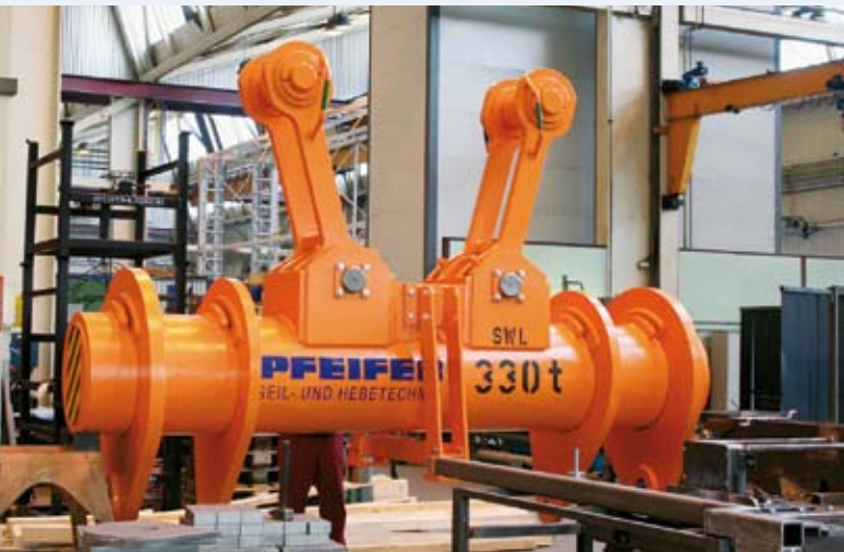
330 t-Traverse fertig zur TÜV-Abnahme.
