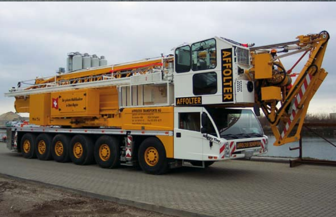
Hat als Spierings-Flaggschiff ausgedient: Der SK 1265-AT6 – hier im Bild eine Maschine, die unlängst an den schweizer Krandienstleister Affolter geliefert wurde – ist hinsichtlich des maximalen Lastmoments deutlich vom SK 2400-AT7 mit 280 / 240 : 132 mt distanziert worden.
