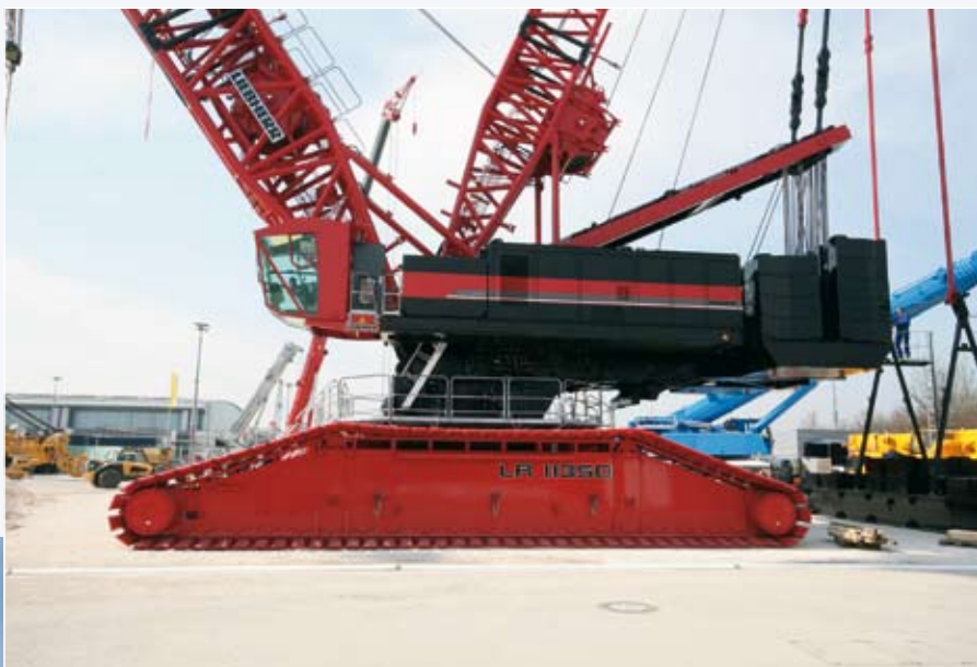
Schon in der vorletzten März-Woche begann der Aufbau der LR 11350 in München. Wer ein Fan solcher ganz „dicken Babies“ ist, der wird sich mit Sicherheit an diesem 1.350-Tonner in Mammoet-Farben etwas länger aufhalten. Bei allem Respekt vor den 1.200 t Tragkraft des LTM 11200-9.1: Zieht man die Tragfähigkeit gemessen als Lastmoment in mt zu Rate, dann wird schnell klar, dass es da einen erheblich größeren Unterschied gibt, als lediglich 150 t maximale Tragkraft. KM-Bild
