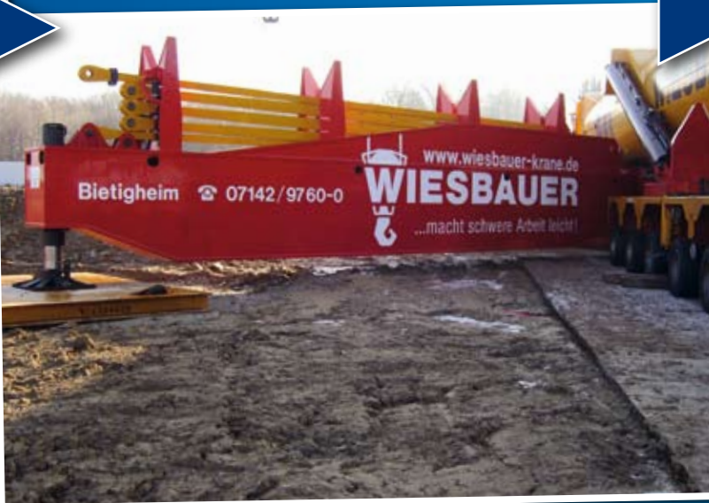
Gut zu erkennen: die gelben Abspannstangen, die zusammengeklappt auf den Abstützungen gelagert werden.
