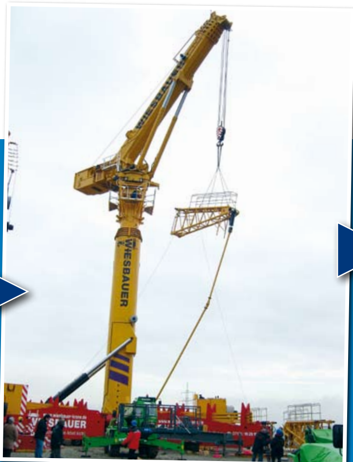
Anbringen der Spreader in Selbstmontage.
