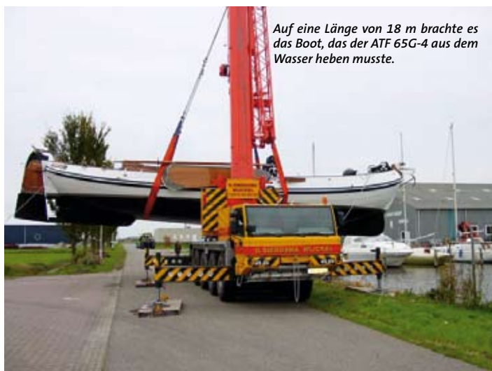
Scheinbar mühelos handhabt der ATF 65G-4 die 35,2 t Gewicht des Bootes.
