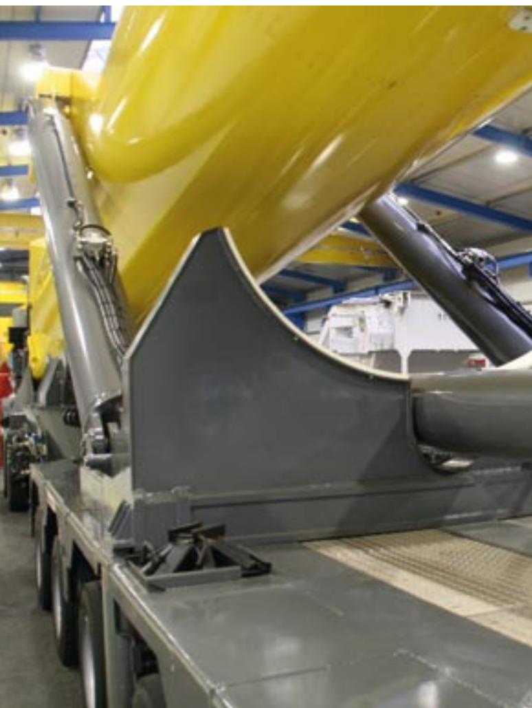
◀ In der neuen Halle wird der komplette Unterwagen bis zum Grundausleger des Vertikalturms montiert.
