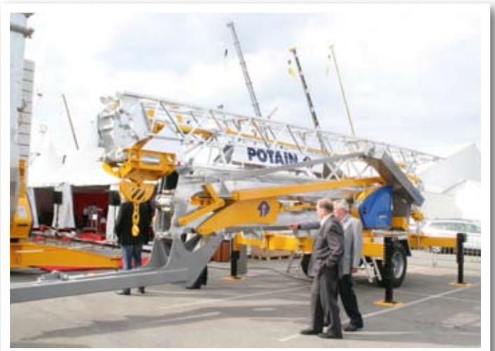
Der Igo MC 13 kann mit Fahrgeschwindigkeiten bis zu 25 km/h gezogen werden. KM-Bild
