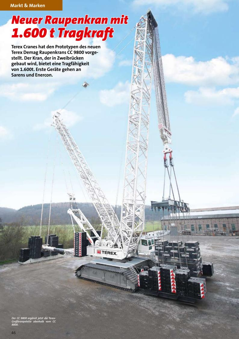
Der neue CC 9800 basiert nach Terex-Angaben auf dem CC 8800-1 und verwendet die gleichen Maschinenkomponenten wie der größere CC 8800-1 Twin, der eine Tragfähigkeit von 3.200 t bietet.
