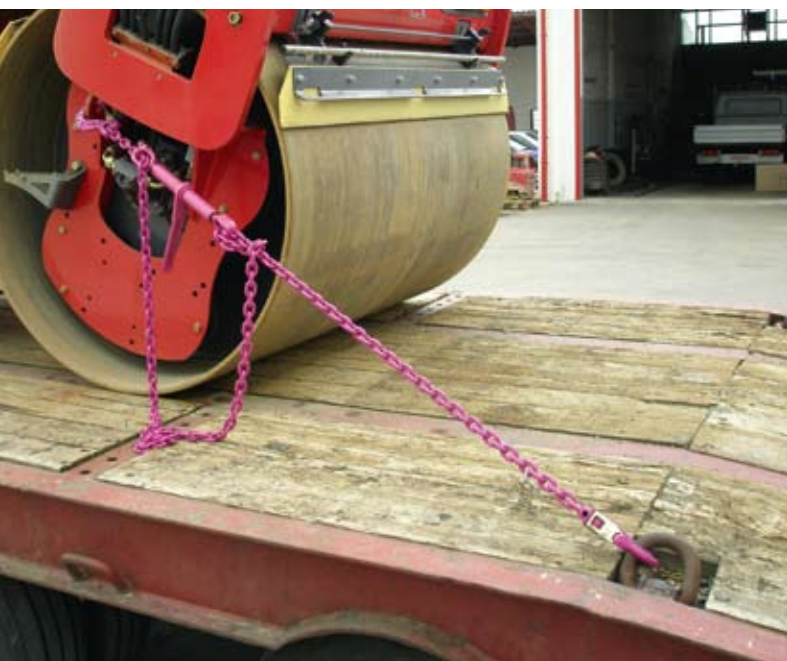
Für den Ver lader bedeutet der Einsatz von ICE-Zurrketten 45 % Gewichtsersparnis, verbesserte Ergonomie, schnelleres Anbringen und mehr Sicherheit.
