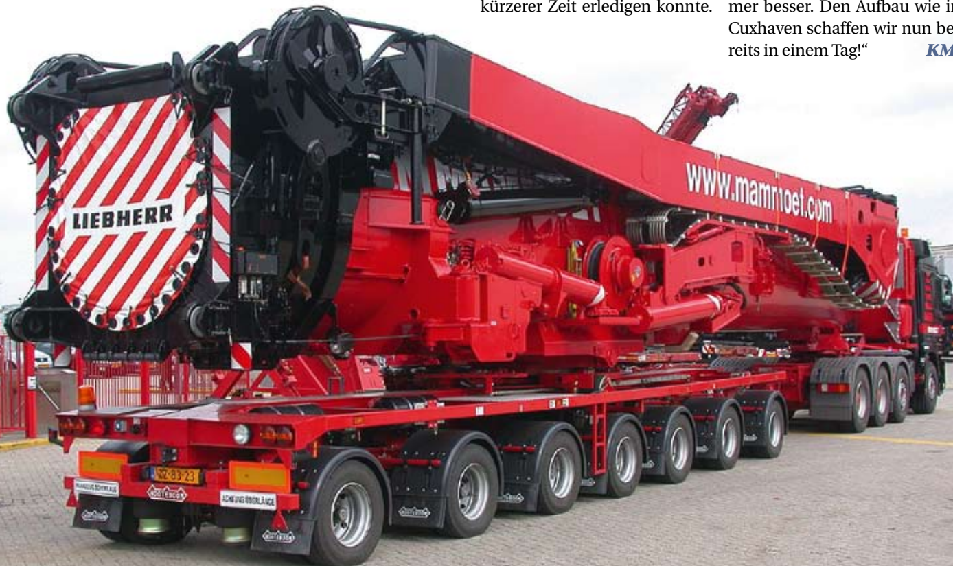
Der Ausleger des LTM 11200-9.1 wird separat transportiert. Hierfür kommt ein Fahrzeug von Nooteboom zum Einsatz.
