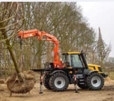
Hinter der Fahrerkabine des 127 kW starken JCB 2170 ist genug Platz für den Ladekranaufbau.
