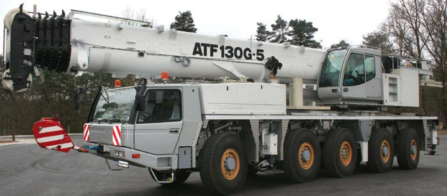
Der ATF 130G-5 mit neuem 5-achsigen Chassis mit Allradlenkung überzeugt mit durchgängig starken Traglastkurven.
