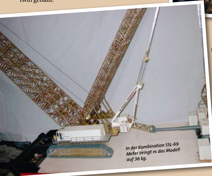
Die Gittermastteile sind aus Messingrohr gefertigt.
