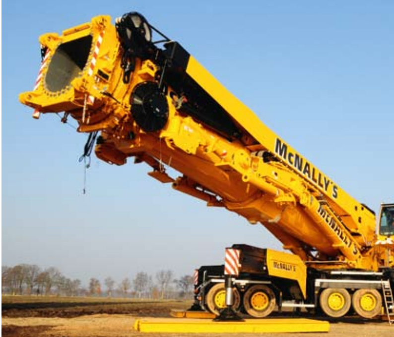
Während der De-/montage sind die Auslegerteile abgestützt.
