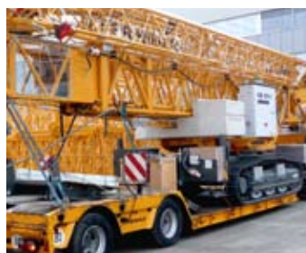
Der 42 KR.1 kann mit komplettem Ballast stehend verfahren werden.
