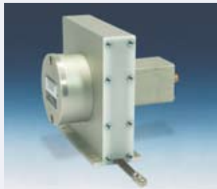
Der neue Sensor WB17KT ist lieferbar mit den analogen Ausgänge 0...10 V, 4...20 mA, 1kΩ, digital absolut SSI oder CAN-Bus. Der elektrische Anschluss erfolgt über M12- oder D8-Stecker.
