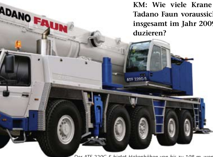
Der ATF 220G-5 bietet Hakenhöhen von bis zu 108 m, wenn er mit der 37,2 m langen Hauptauslegerverlängerung zum Einsatz kommt.
