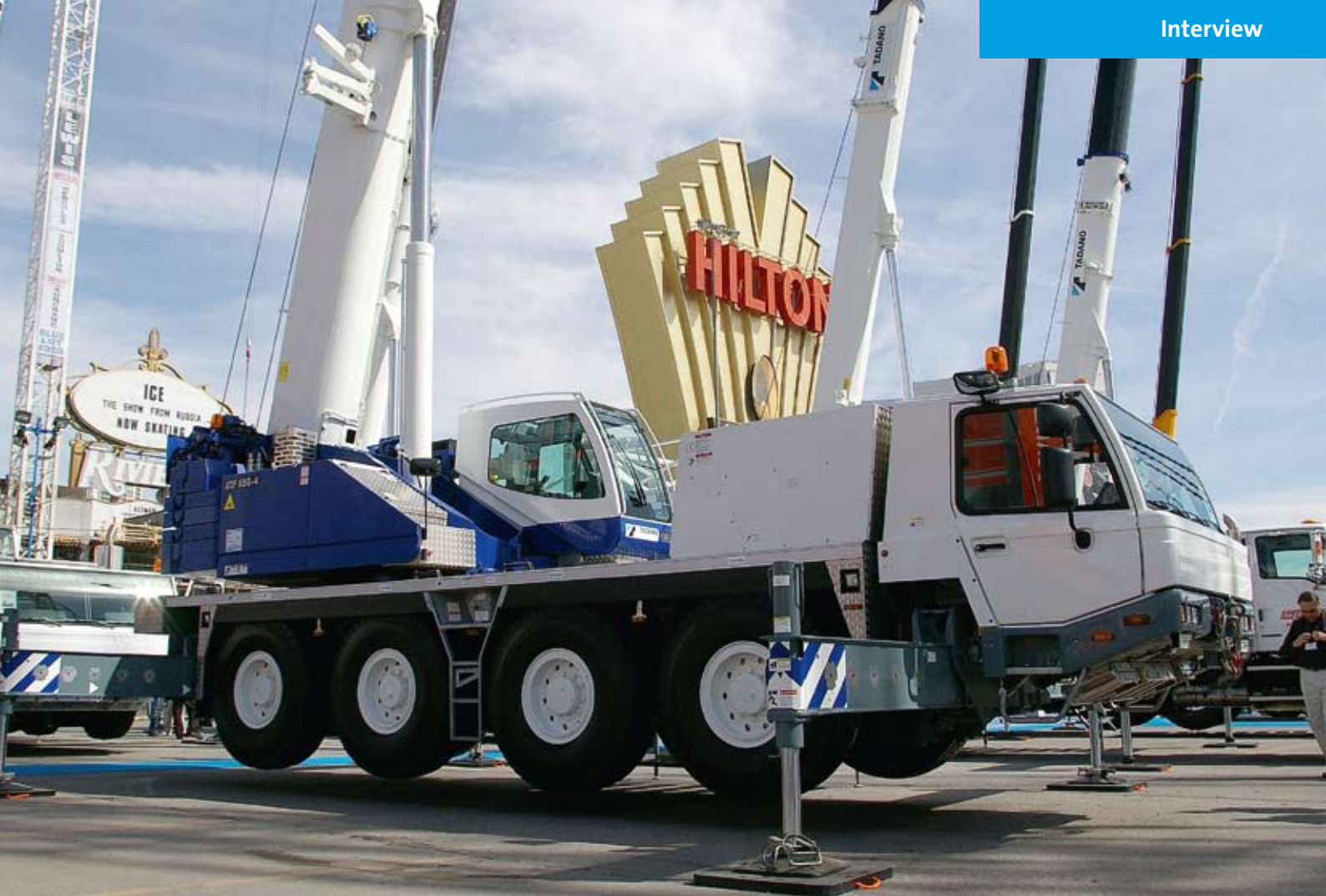
Der ATF 65G-4 bietet einen 44 m langen Hauptausleger. Der Kran kann auch mit einer 1,6 m-Schwerlastspitze ausgerüstet werden.
