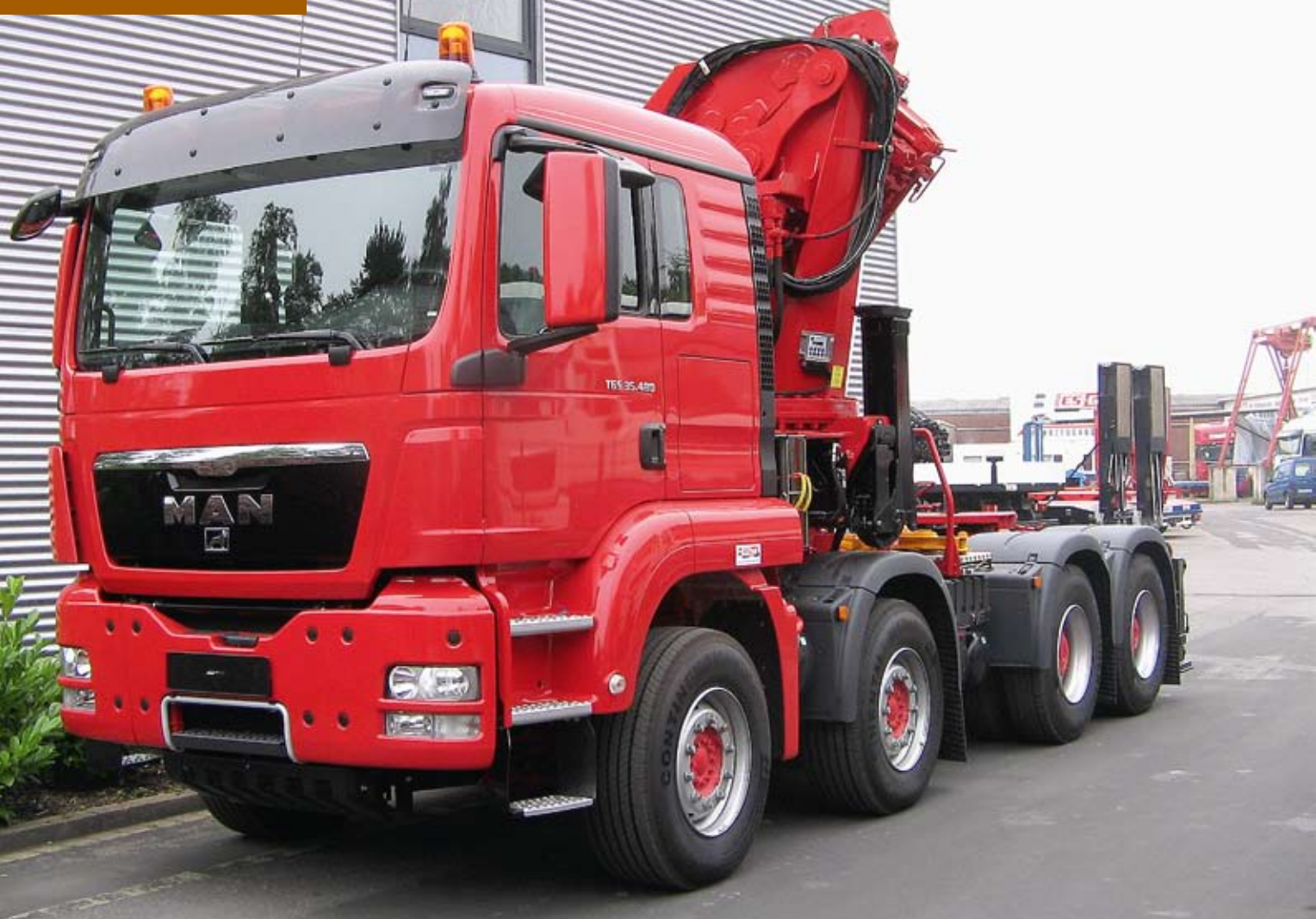
Der MKG-Ladekran HLK 671 HPa6, der bei ES-GE aufgebaut auf eine MAN-4-Achs-Sattelzugmaschine, Typ TGS 35.480 8x4 BL, angeboten wird, bietet ein Lastmoment von 62 mt. In Tragkraft ausgedrückt bedeutet dies zum Beispiel 12,35 t bei 4,55 m und 3,05 t bei 16 m. Bei einem solchen 62 mt-Kran, aufgebaut auf eine 4-achsige Sattelzugmaschine verbleibt auch noch eine ganze Menge Sattelast.
