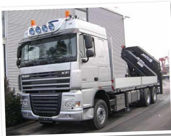
Heben und transportieren: Diesen DAF-3-Achs-Lkw XF 105.460 SC mit MKG-Ladekran HLK 541 bietet ES-GE an. Hier wurde ein Ladekran der 50 mt-Klasse mit einem Container-Pritschenaufbau kombiniert. Bild: ES-GE
