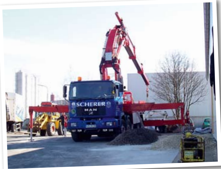
Ladekrane übernehmen inzwischen auch Telekran-Aufgaben (im Bild ein Cormach-Ladekran), bieten aber auch zusätzliche Optionen ... Bild: Hermann Schulte
