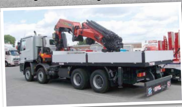
Dieser Daimler-Benz-4-A-Lkw, Typ 4144 8x4/4 mit Palfinger Ladekran PK85002 wird ebenfalls durch ES-GE angeboten. Dieser Ladekran bietet ein maximales Lastmoment von 80 t, das sind 25 t Tragkraft am kurzen Ausleger. Ab etwa dieser Größenordnung des Ladekrans und erst recht, wenn es in die Bereiche über 100 mt geht, ist die Lkw-Kran-Einheit in erster Linie ein Kran, die verbleibende Nutzlast reicht aber auf jeden Fall, diesen Kran in Vollausrüstung auf die Straße zu bringen und gegebenenfalls noch Zubehör für einen größeren Kran zu transportieren und zu heben.
