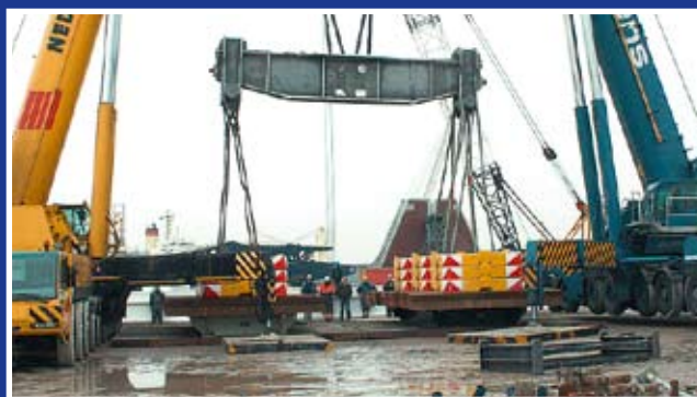
▲▼ Zwei Großkrane beim Belastungstest einer 350 t- Traverse: Das ist natürlich nicht ganz billig gewesen.
