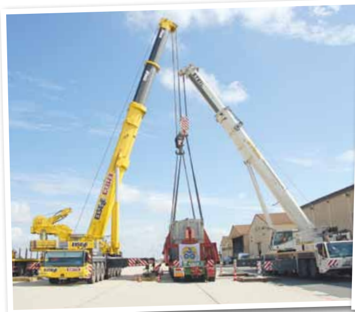
◀▶ Umschlag des Transformators auf die Schwertransporteinheit und Umsetzen der Krane.
