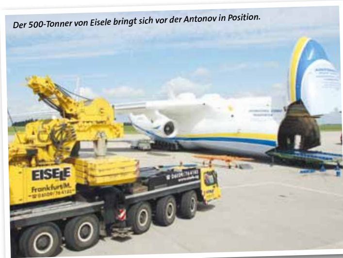
Im Tandemhub gehts auf die Verladerrampe und dann in den Laderaum der Antonov.
