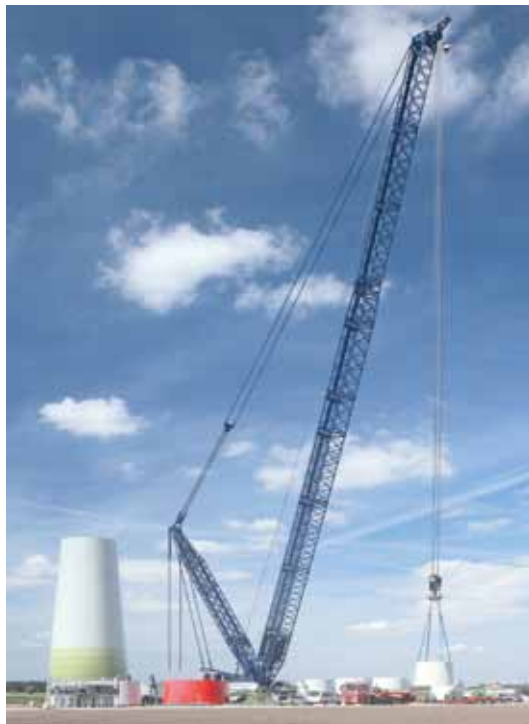
Der Liebherr LR 1600/2 von Maxikraft hat sich bereits beim Aufbau von Windkraftanlagen bewährt.
