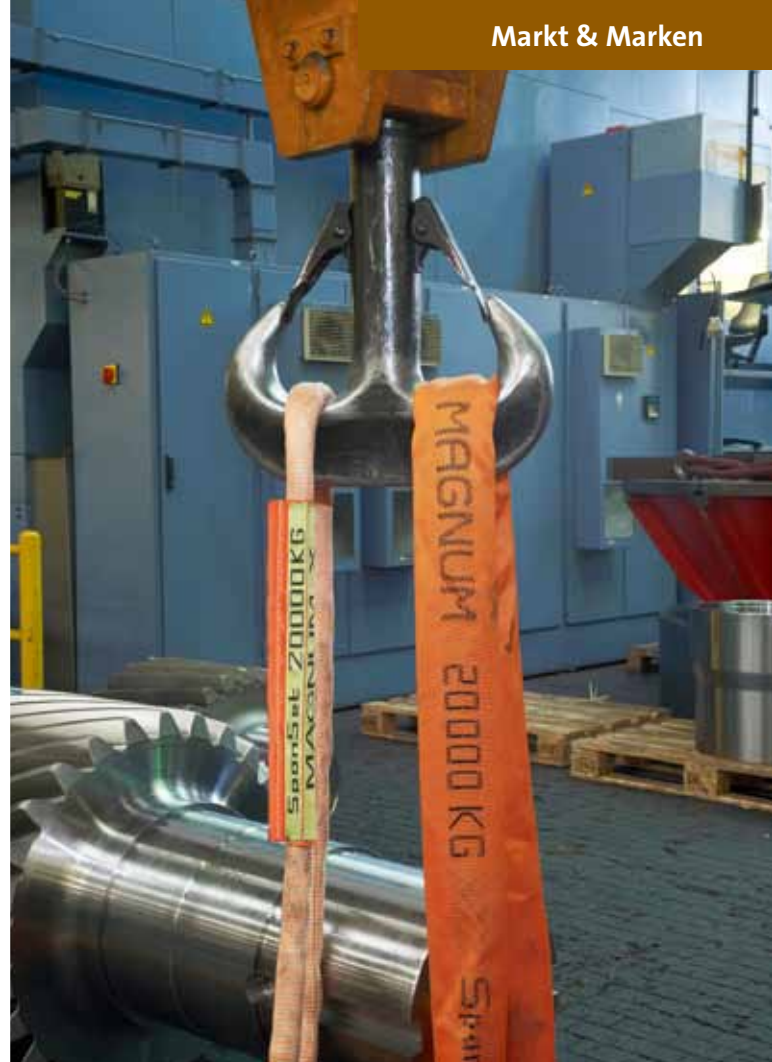
Zwei Rundschnuren, zwei Mal 20.000 kg Tragkraft! Gut zu erkennen ist der Unterschied zwischen der Magnum-X (links) und der Magnum: Die Magnum-X ist deutlich schmaler.
