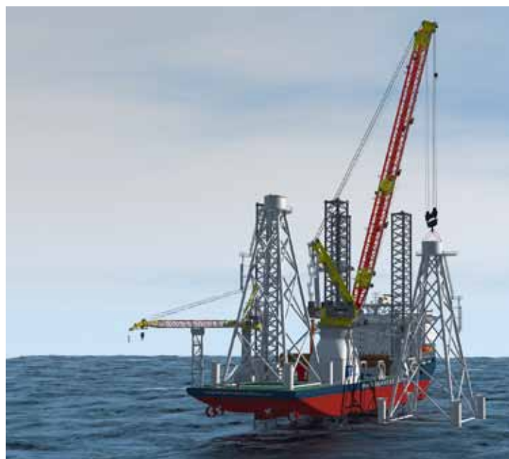
Über Deck verfügt der neue Kran-gigant über eine Hakenhöhe von über 120 m, der Kranausleger ist 105 m lang.
