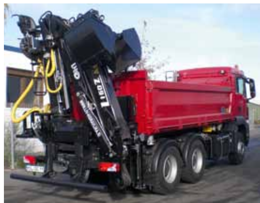
Dieser MAN-Kipper wurde mit einem LIV-Kran der neuen Z-Reihe ausgerüstet.
