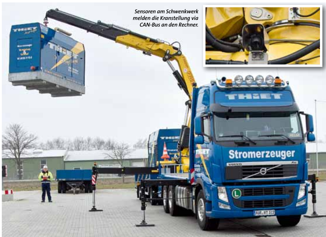
Die Fassi Stabilitätskontrolle FSC ist in drei Varianten verfügbar. Die Jürgen Thiet GmbH entschied sich für die Ausführung FSC/S wie Super, die für Kranerien ab F245A mit FX800 Steuerung, ADC, Funkbedienung RCH/RCS und hydraulisch ausfahrbaren Stützbeinen ausgestattet sind.
