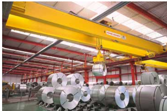
Seilzüge wie CXT Zweischielenkatze und CXT Untergurkatze erbringen in der Stahlproduktion hohe Leistung etwa beim Be- und Entladen sowie Ein- und Auslagern von Lasten.
