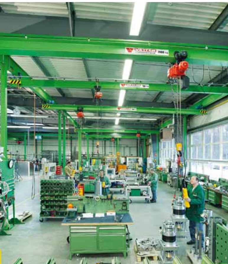
Das PROFI-Kransystem von Vetter Krantechnik verknüpft ausgewählte Fertigungsprozesse miteinander.
