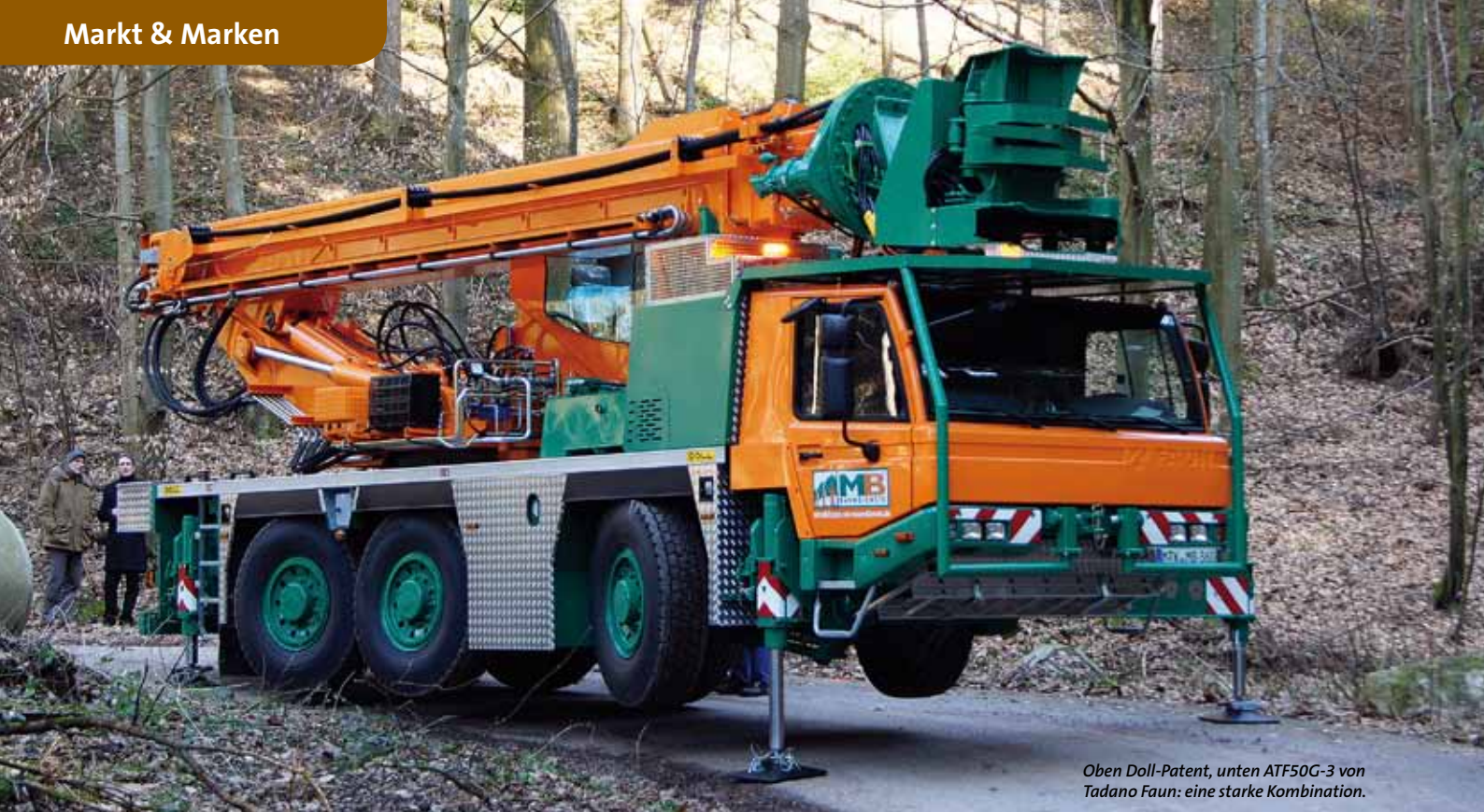
Fahr- und abstütztechnisch bietet der Fällkran alle Vorteile eines ATs. Der modifizierte, bis zu 24,5 lange Teleskoparm ist mit einer Fällmechanik ausgerüstet.
