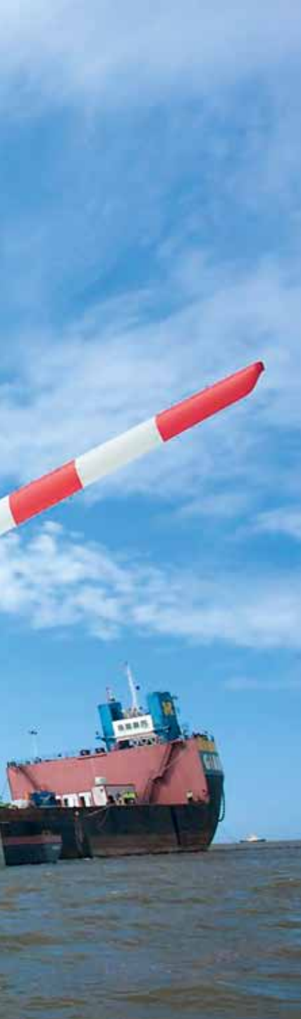
◀▼ Ein CC6800 im „Schwimmkraneinsatz“.
