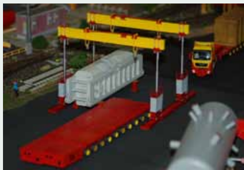
Per Hubgerüst wird die auf quergekuppelte Selbstfahrer geladen. Bild: Hermann Schulte
