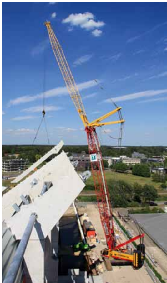
Das Liebherr-Werk Nenzig bietet den Raupenkran LR 1300 optional mit Kohlefaserhalterstangen an.
