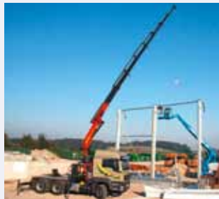
Der PK 34002-SH ist auf einem 3-achsigen MAN 26.480 aufgebaut.
