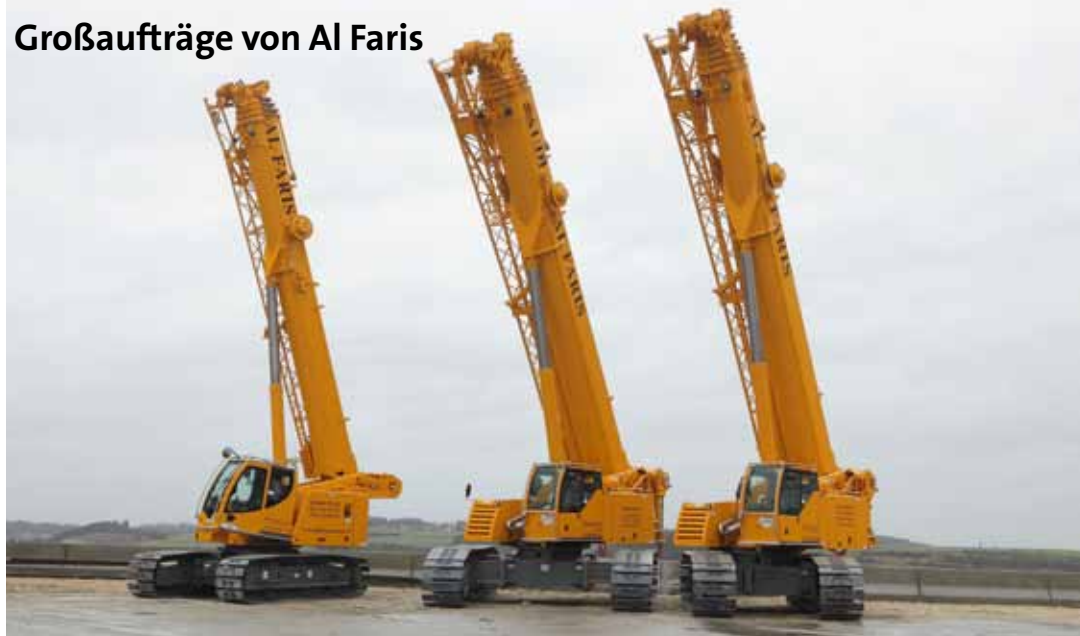
Al Faris entschied sich für Teleskopkrane auf All-Terrain- und Raupenfahrgeräten mit Traglasten zwischen 60 t und 750 t.
