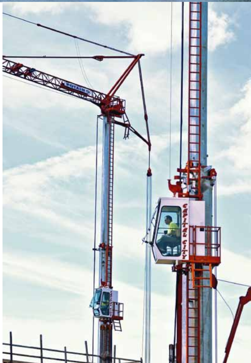
Helper in der Not. Zwei Potain HDT 80 helfen eine Baustelle vorzeitig fertigzustellen, obwohl eine dreiwöchige wetterbedingte Zwangspause eingelegt werden musste. ▼
