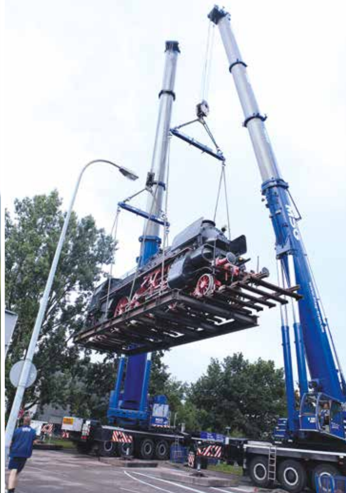
Beim Lokhub Ende Juni in Offenburg kam der LTM 1500-8.1 mit 135 t Ballast und 31,7 m langen Hauptmast zum Einsatz und der LTM 1400-7.1 mit 120 t Gegengewicht 30,6 m Teleausleger.
