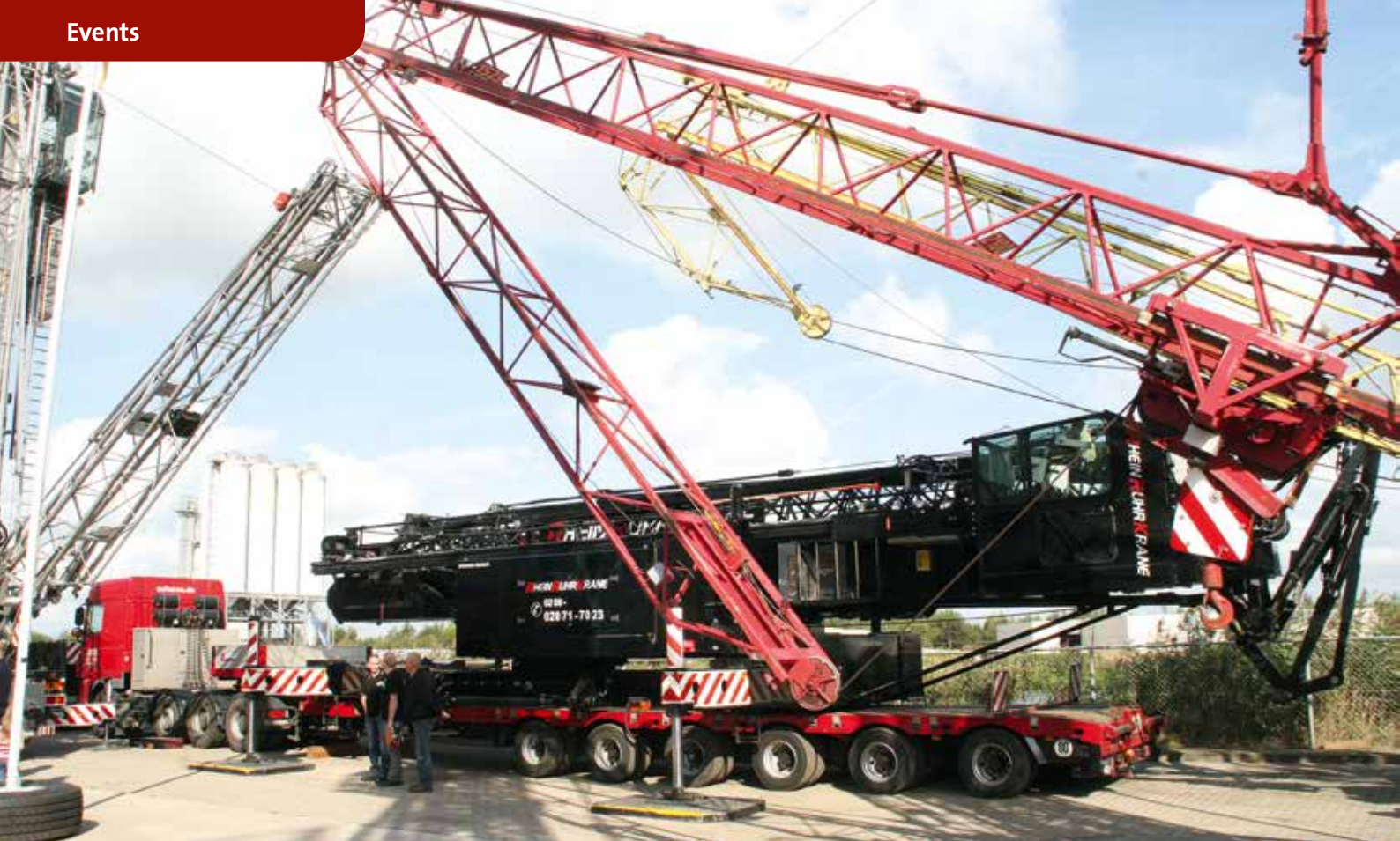
War in Oss mit dabei: die dritte Variante eines SK 2400 – aufgebaut auf einem modifizierten Semi-Tieflader.
